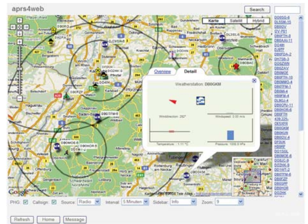
Bild 3: Webbasierte Visualisierung des APRS-Verkehrs mit APRS4WEB
