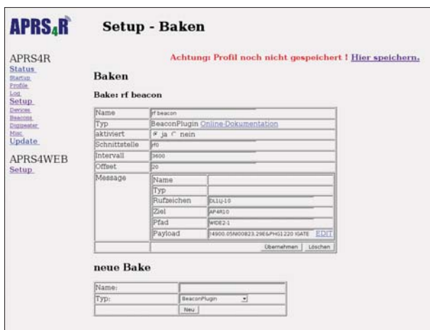
Bild 2: Webschnittstelle zur Konfiguration und Administration von APRS4R
