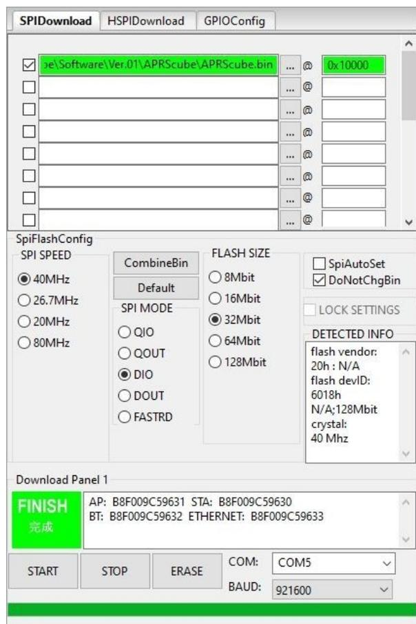
Jetzt noch den COM-Port auswählen und auf "START" klicken. Das ist alles. Nach dem Programmieren dann einmal kurz den seitlichen Reset-Taster betätigen und der APRScube sollte starten.
